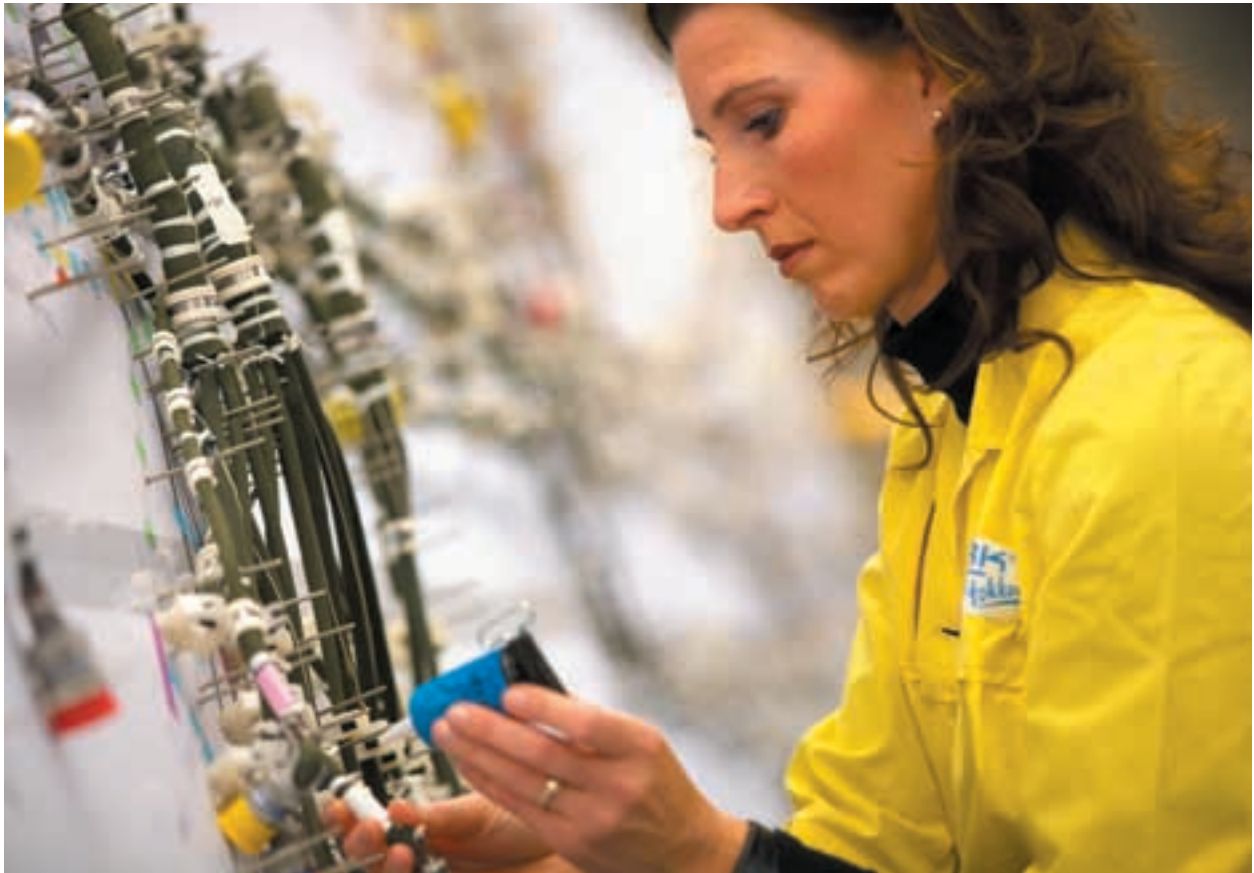
De configuratie van bekabelingsystemen luistert zeer nauw en is een van de specialismen van Fokker Elmo.
