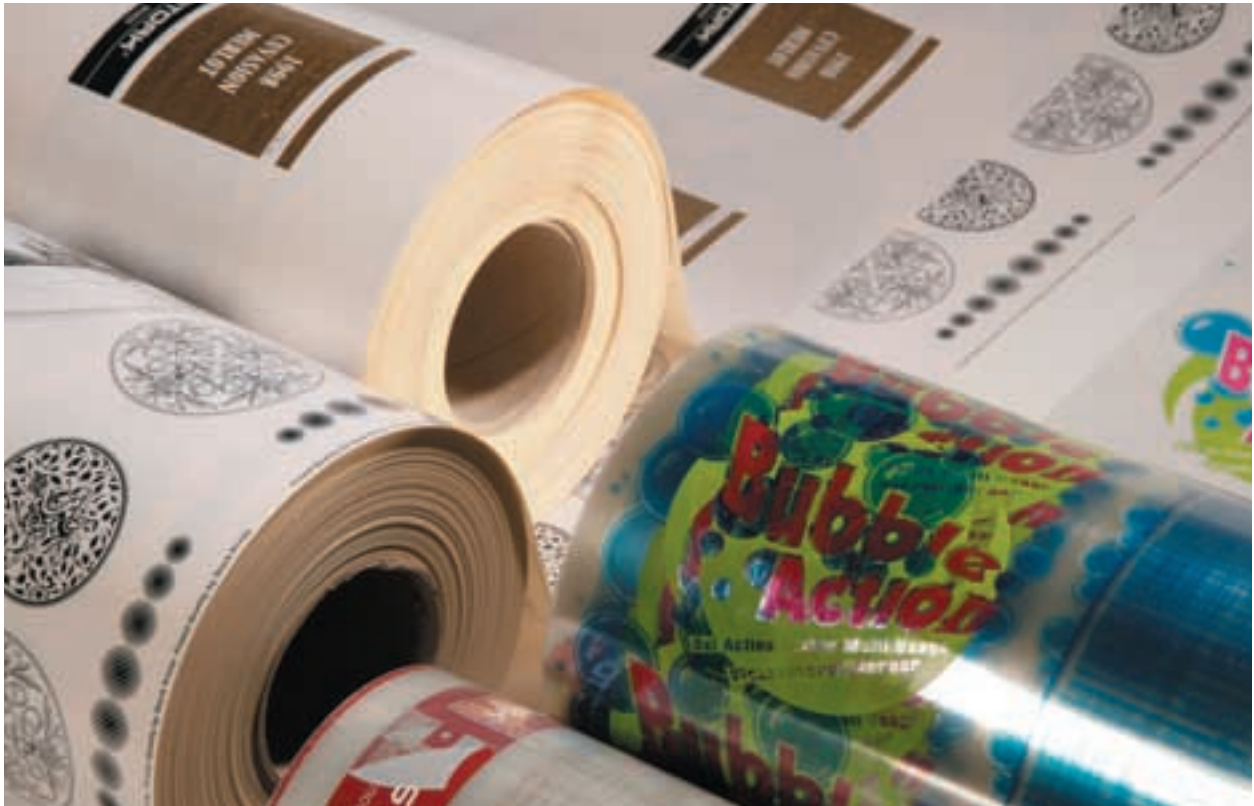
Met rotatiezeefdruk kunnen tot 300 micrometer dikke structuren worden aangebracht op elke denkbare ondergrond.
